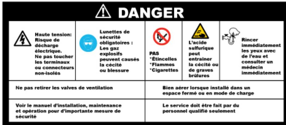
Figure 1 – Etiquette de mise en garde BCI
